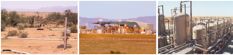
Bild 3. In-Situ-Laugung (ISL), Beverley-Lagerstätte; links: Brunnenfeld mit belassener Vegetation als Beispiel umweltgerechten Bergbaus, mitte: automatisierte Aufbereitungsanlage nach modernsten Sicherheitsstandards, rechts: Aufbereitungsanlage (vgl. Bild 4).
